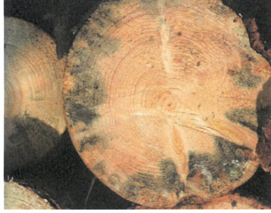
Zamodráání větší než ¼ tloušťky čela čepu a počínající paprsky hniloby !
