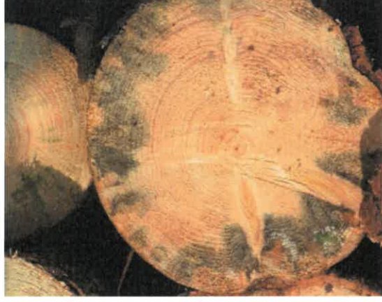
Zamodrání větší než ¼ tloušťky čela čepu a počínající paprsky hniloby !
