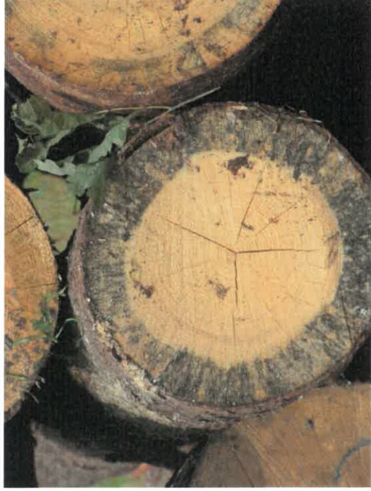
Zamodrání větší než ¼ tloušťky čela čepu
