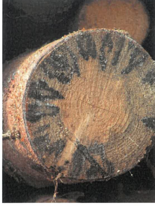
Zamodrání větší než ¼ tloušťky čela čepu
