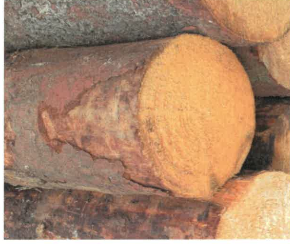
Zamodrání menší než ¼ tloušťky čela čepu
